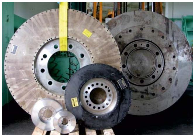
Fig. 10. Torsion dampers
